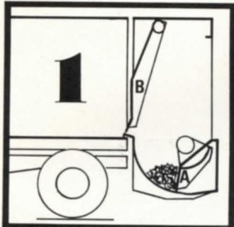
1 Les ordures déversées glissent sur une chute en tôle lisse, devant la pelle d'amenée A, située en position inférieure, tandis que le fouloir B se trouve en position avant, fermant ainsi l'accès arrière du caisson.
