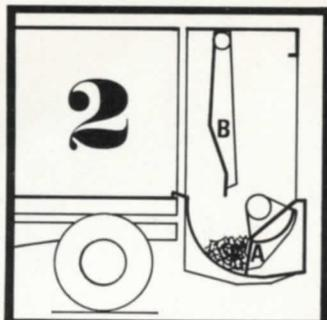
2 La pelle d'amenée A, se trouvant toujours à sa position inférieure, le fouloir B pivote en arrière et libère ainsi la voie de communication entre la trémie et le caisson.
