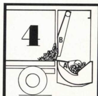
4 Les ordures, pré-tassées, sont retirées de la pelle d'amenée A par le fouloir B, elles sont poussées dans le caisson du fourgon où elles sont fortement comprimées. Ensuite, la pelle d'amenée A pivote pour revenir à sa position finale inférieure. Les ordures qui, dans l'intervalle, ont été déversées et qui se sont entassées entre la pelle d'amenée A et le bord inférieur de la trémie, glissent devant la pelle d'amenée (voir position 1).
