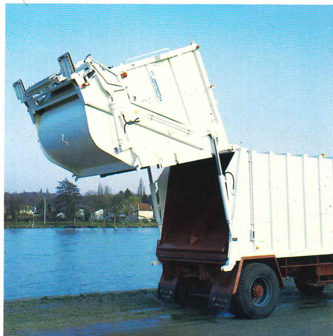
Ouverture totale Panneau éjecteur sortant du caisson mu par vérin double effet
