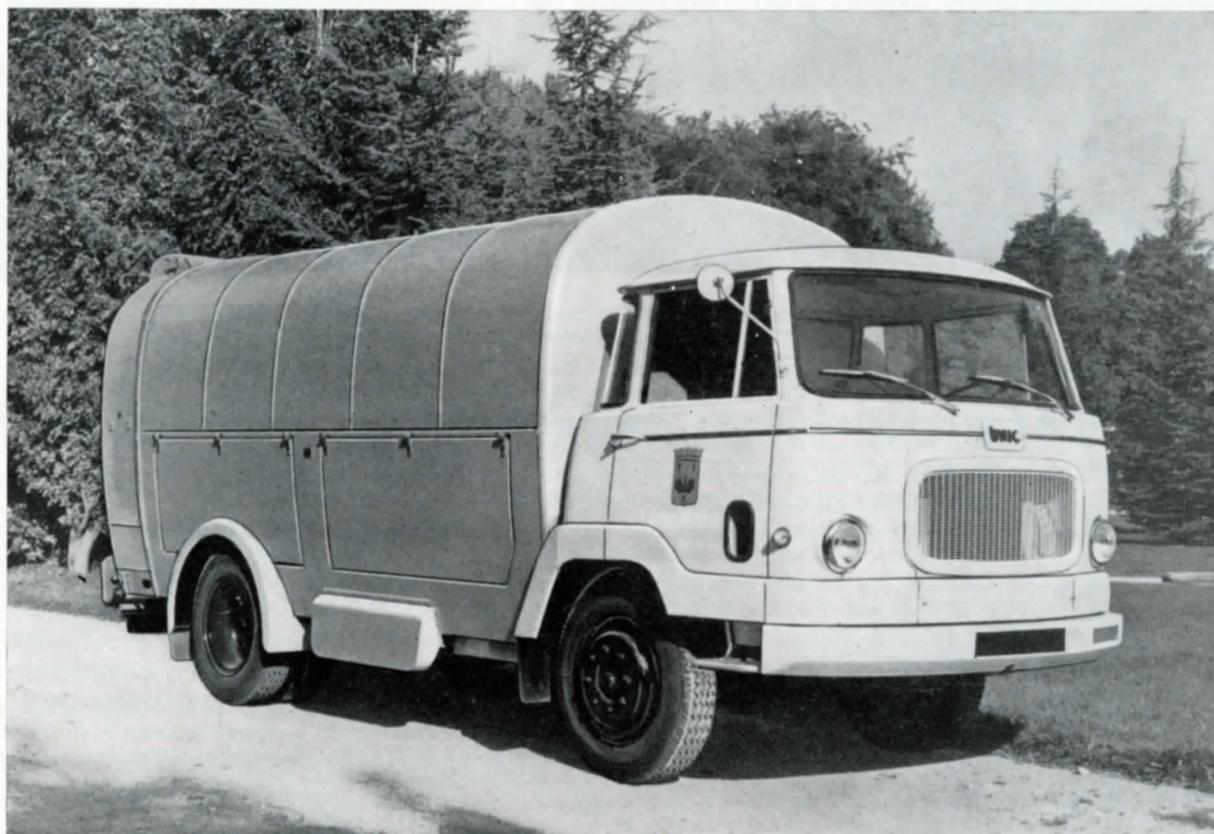
"HÉLICO" de 6 m<sup>3</sup> 500 de volume de cylindre pouvant transporter de 11 à 13 m<sup>3</sup> d'ordures en vrac sur châssis cabine avancée **MZU 34 CA** — Type **DONON**.
