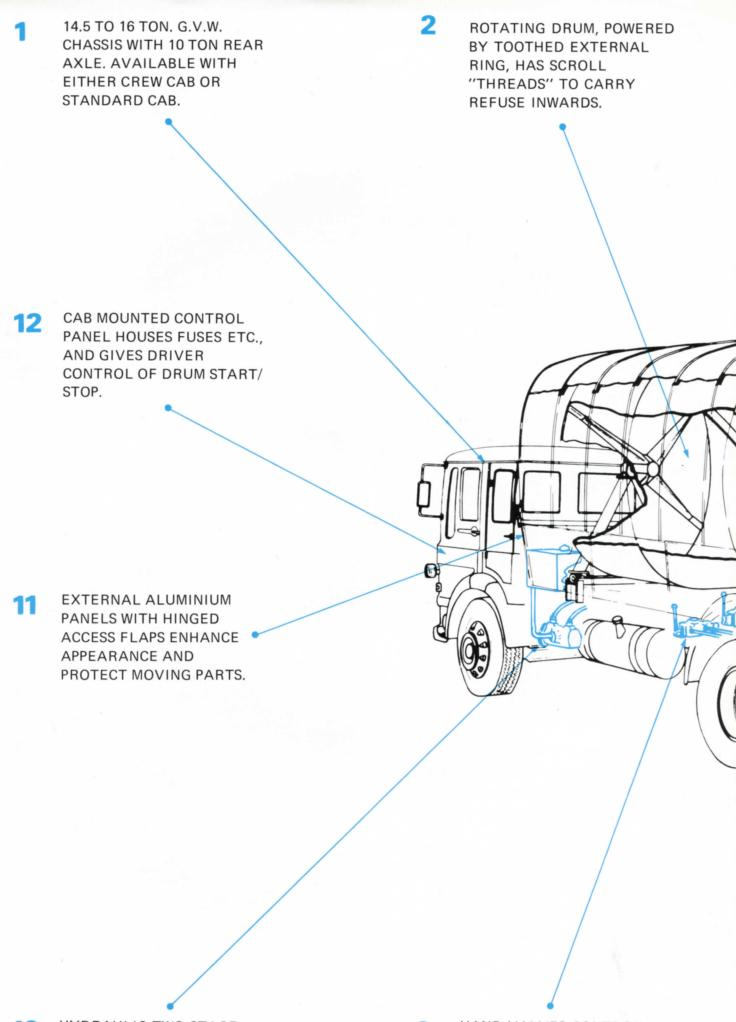
10 HYDRAULIC TWO STAGE PUMP IS DRIVEN BY POWER— TAKE—OFF UNIT ON VEHICLE GEARBOX. HAND VALVES CONTROL
