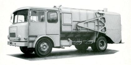
Der FAUN-Preßmüllwagen nimmt 36 cbm Müll auf. Der Müllbehälter ist aus Stahlblechen mit Gerippe aus Preßprofilen vernietet und verschweißt und mit dem Kipprahmen fest verbunden.
