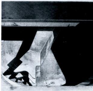
Der Arm der Preß-Vorrichtung mit den Scheren zur Müll-Zerkleinerung aus hochvergütetem Stahl.
