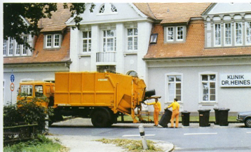
Geräuscharme Arbeitsweise durch hydraulisch angetriebene Preßeinrichtung
