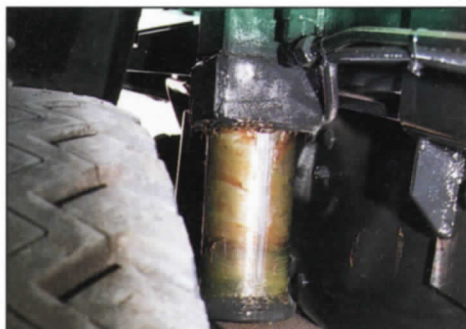
Hydraulische Achsabstützung für hohe Hubkraft bei kurzem Radstand
