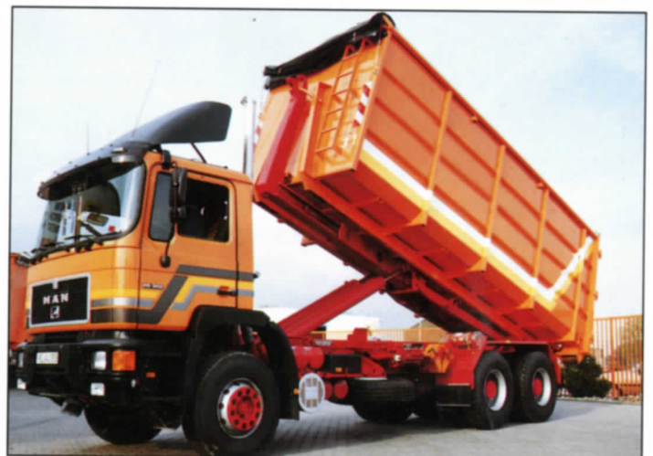
GEORG-Hakenlift auf 3-Achs-LKW mit Großcontainer-Präsmüllbehälter
