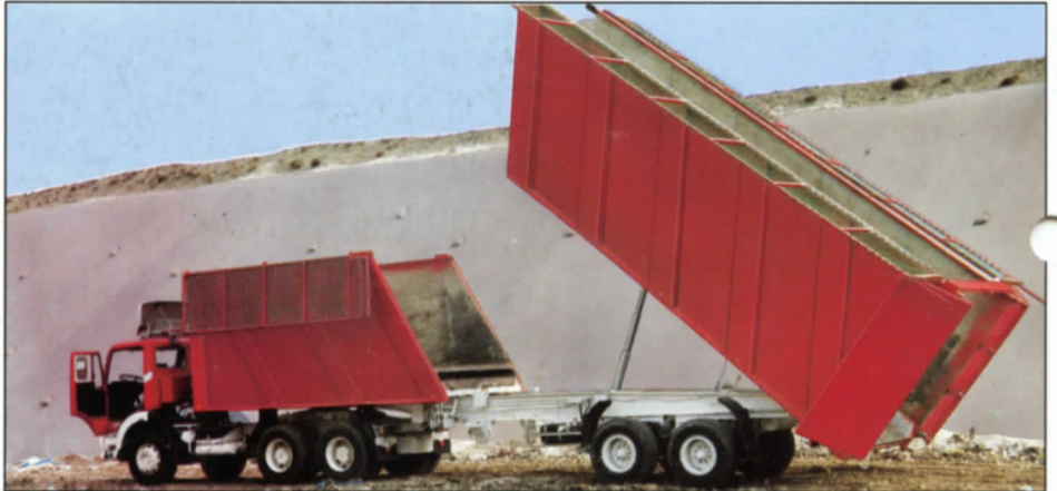
Schubkipper-Sattelanhänger zum Transport von Müll über größere Entfernungen via Umladestation
