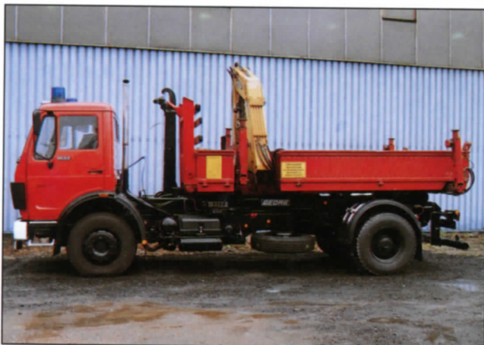
GEORG-Hakenlift auf 2-Achs-LKW mit Kran auf Container montiert
