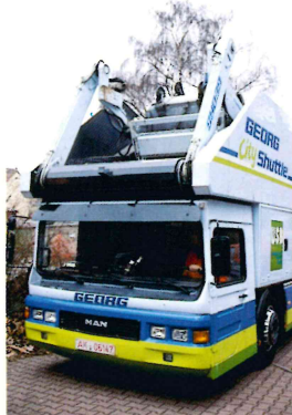
Die Behälter bleiben während des gesamten Hebevorgangs in senkrechter Stellung und werden erst über dem Pressenraum gekippt
