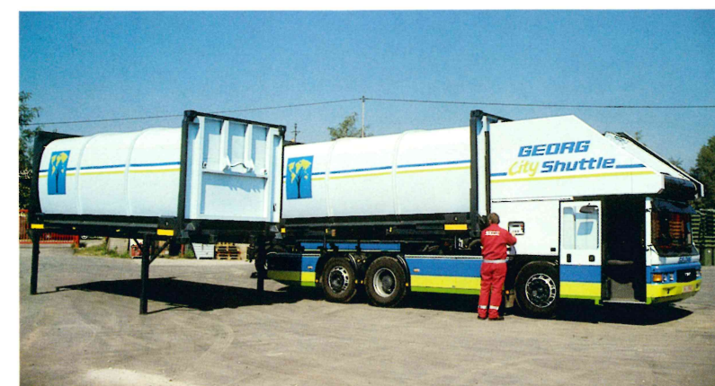
Innerhalb weniger Minuten ist der gefüllte 20-ft-DIN-Wechselcontainer abgestellt und ein neuer, leerer Container aufgenommen
