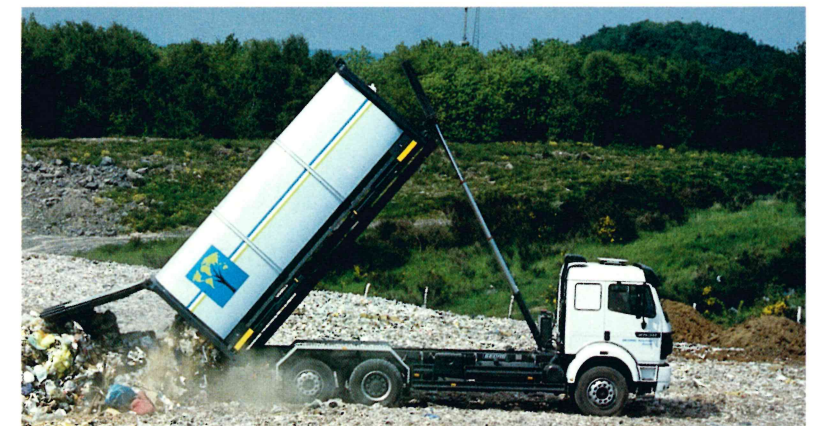
Die Entleerung der Container erfolgt durch Kippen
