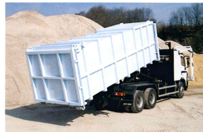
GEORG GewerbeShuttle beim Absetzen des Containers
