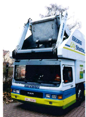
Die Behälter bleiben während des gesamten Hebevorgangs in senkrechter Stellung und werden erst über dem Pressenraum gekippt
