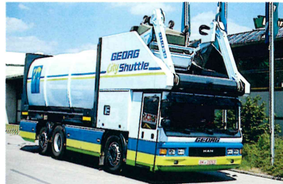
GEORG CityShuttle beim Schütten eines Behälters
