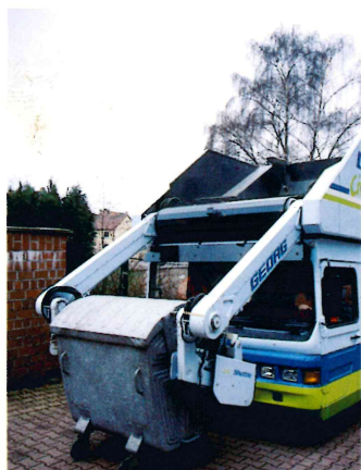
Die Behälter bleiben während des gesamten Hebevorgangs in senkrechter Stellung und werden erst über dem Pressenraum gekippt
