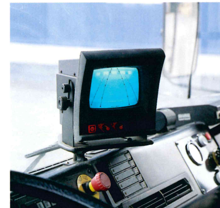
Der Schüttvorgang wird per Monitor überwacht
