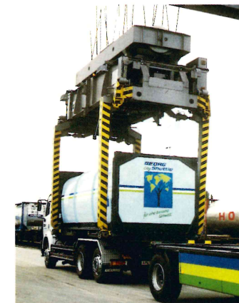
Containerübernahme mit Krangeschirr
