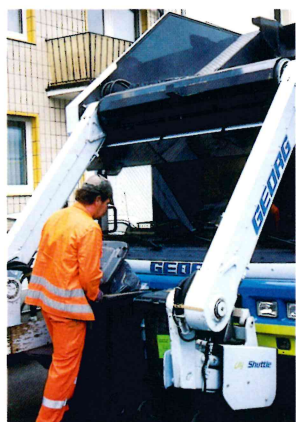
Der Lader stellt die Behälter an die Schüttung
