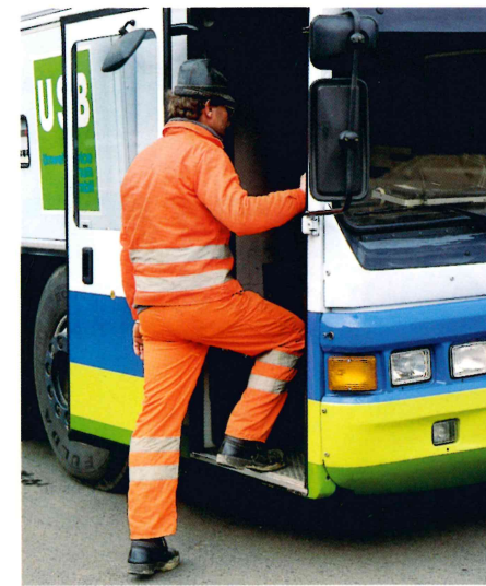
Über einen bequemen Niederflureinstieg gelangt der Lader schnell und mühelos ins Fahrerhaus
