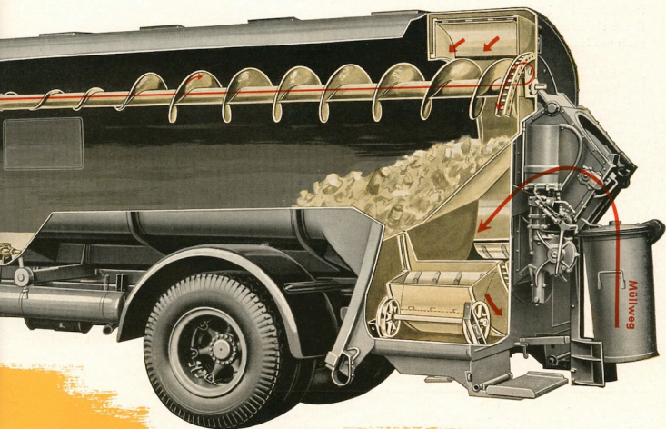
ufbau des HALLER Müllwagens. Die rote Linie kennzeichnet erschnecke. Der Müllweg ist gleichfalls rot eingezeichnet.
