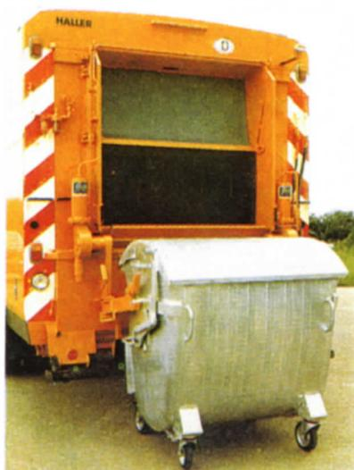
Einschüttöffnung für Müllsäcke und dergl. zwischen den Systemschüttungen
