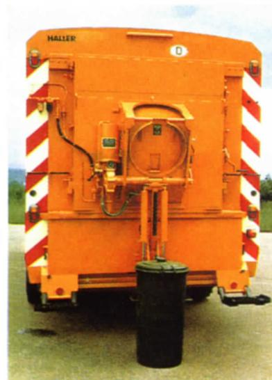
Einzelschüttung für 60/90/110 Liter Ringmülltonnen nach DIN 6629
