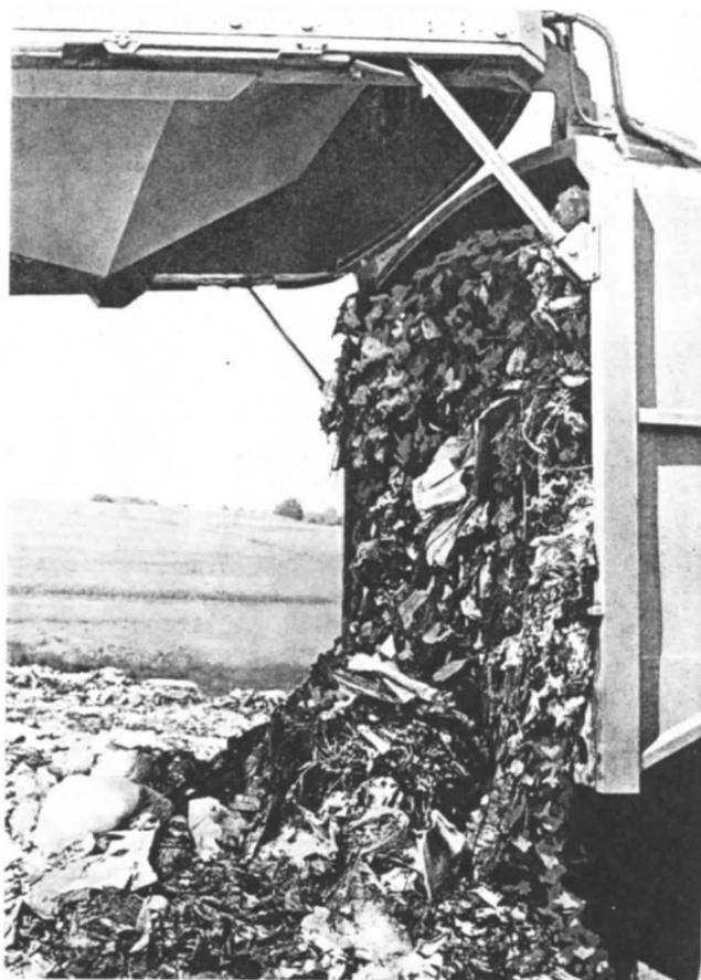
Das Entleeren des Wagens erfolgt mit einer Ausschubplatte, die über einen Mehrkolben-Arbeitszylinder hydraulisch angetrieben wird. Sie kann auch nicht verkanten, da die Hydraulikpresse unmittelbar an der Ausschubplattenführung so angeordnet ist, daß ungleich angreifende Kräfte sicher abgefangen werden.
