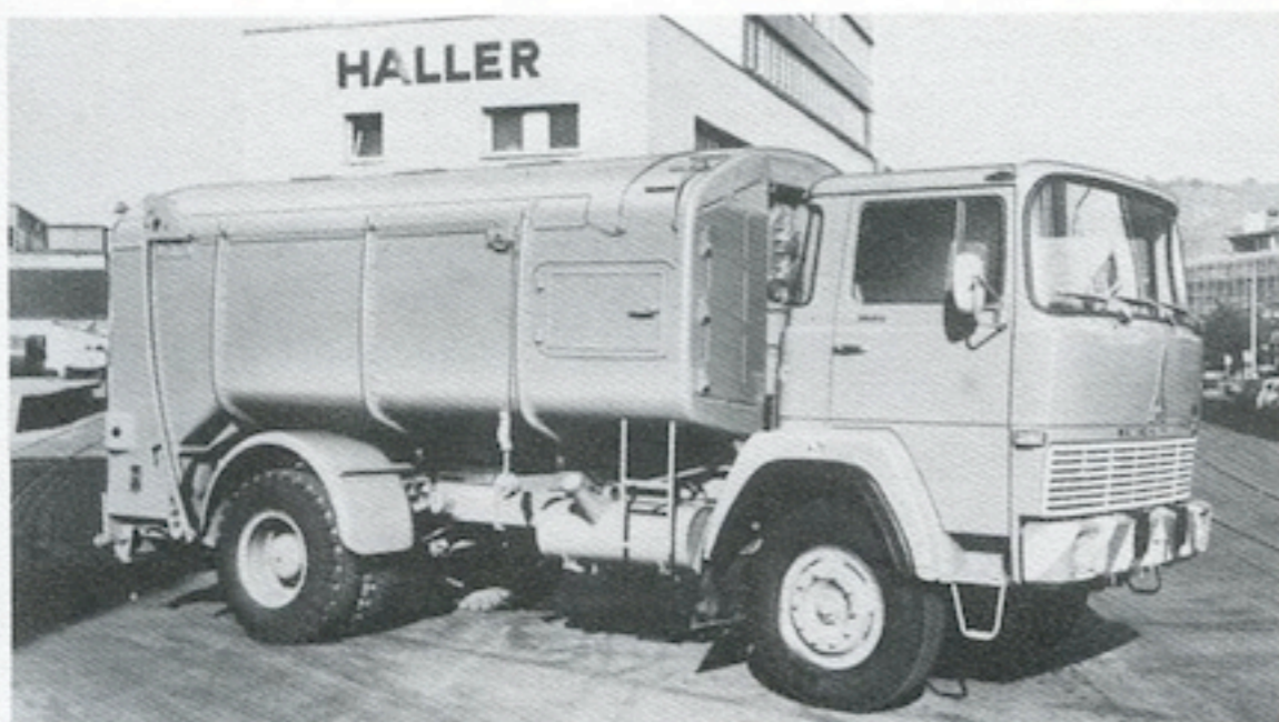
Haller-Müllwagen-Aufbau Typ 3110, mit einem Laderaum von 10 m 3 , für Hausmüll.
