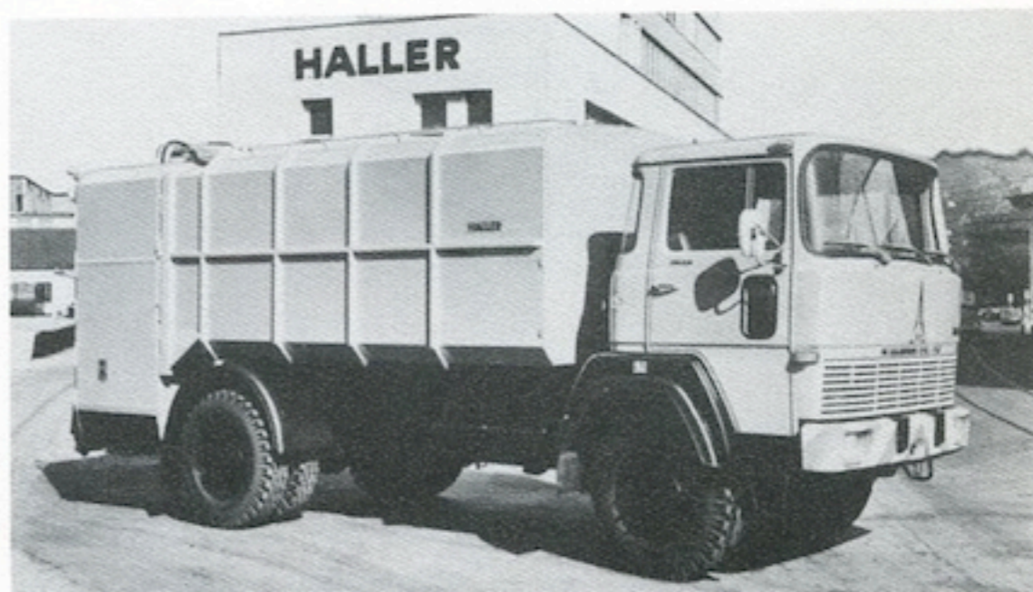
Haller-Kompaktmüllwagen-Aufbau Typ M 11 S, mit einem Behälter-Volumen von 11,5 m 3 , für alle Müllarten.
