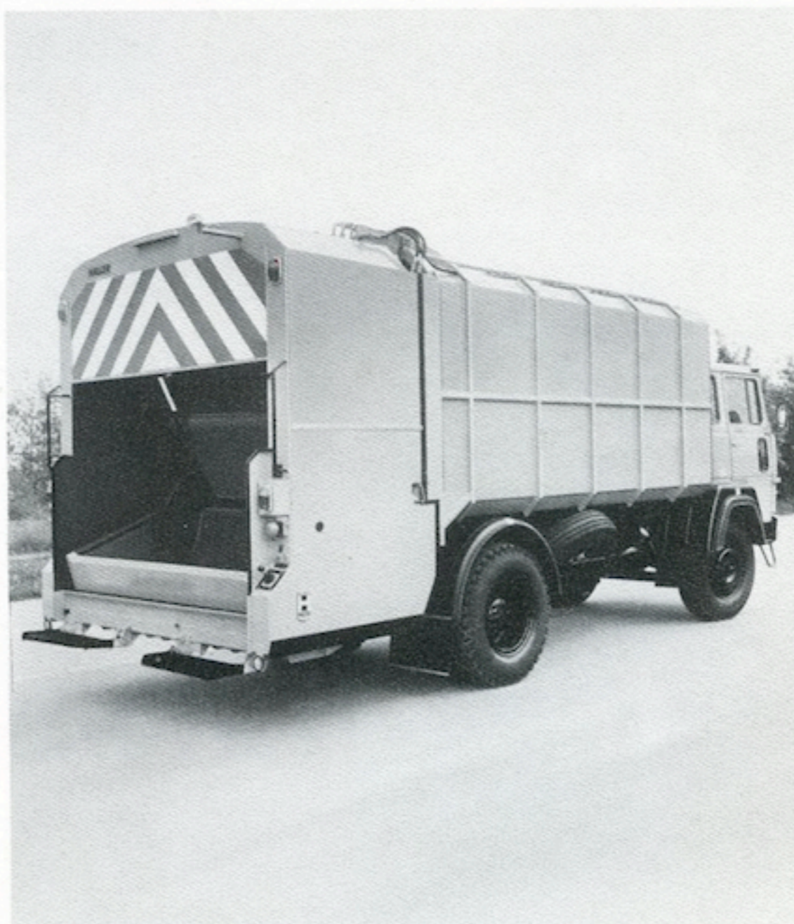
Haller-Kompaktmüllwagen-Aufbau Typ M 15 C, mit einem Behälter-Volumen von 15 m 3 , für Sperrmüll.
