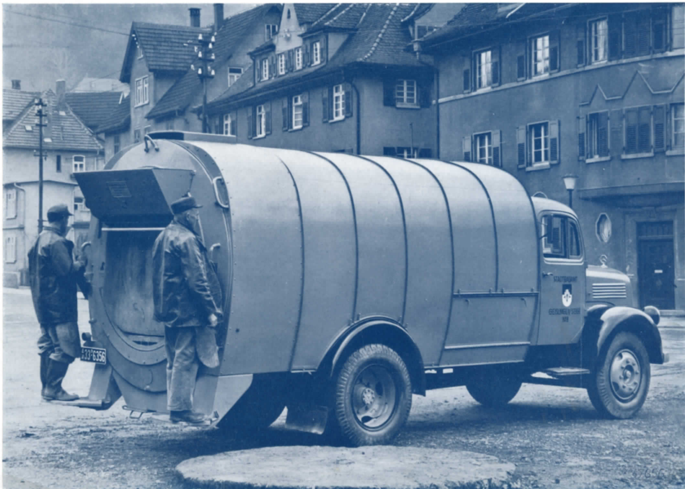
6 cbm MBK-Müllwagen mit Universalschüttung
