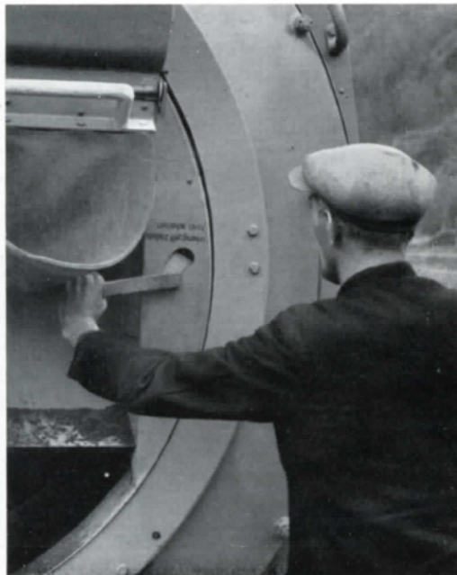
Von der Entladestellung wird wieder auf die Beladestellung zurückgeschaltet, womit das Fahrzeug wieder beladen werden kann
