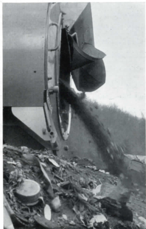
Entleerung auf der Müllhalde ohne Kippung
