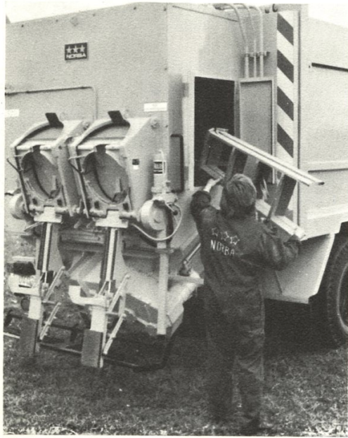
Sperrgutluke über der Preßschnecke für größeren Müll, damit die Zöller-Schüttung nicht geöffnet werden muß.
