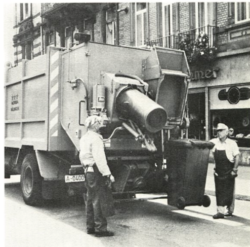
Auswechselbare Blende mit Kombination von Mülltonnenschüttung 60/90/110 Liter und Großmülltonnen GMT 220.
