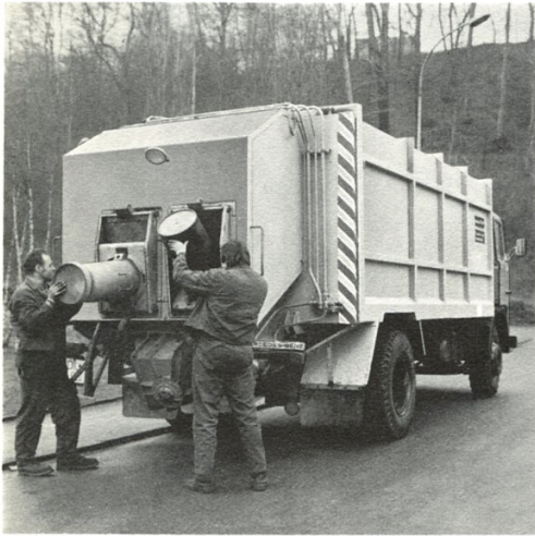
Mülleimer-Doppelschüttung für Mülleimer nach DIN 6628 (35, 50, 70 Liter). Hakenhöhe bei Hand-schüttung 1250 mm.
