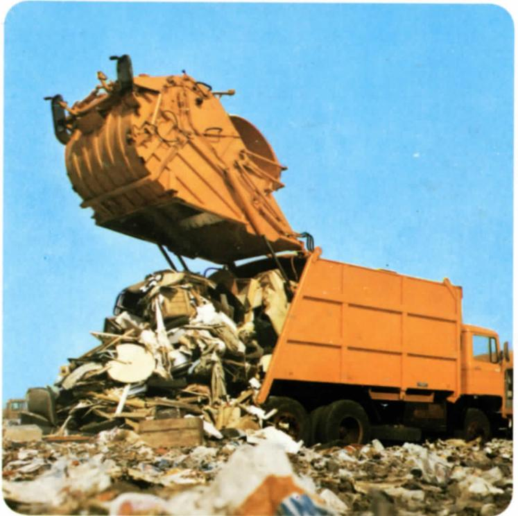
**Entleeren:** Zur Entleerung des Fahrzeugs wird der gesamte Beladeteil durch zwei Hydraulikzylinder hochgeschwenkt. Eine automatisch einrastende Sicherheitsstütze verhindert ein unbeabsichtigtes Absenken.
