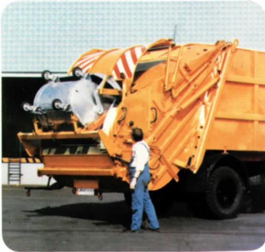
Vielseitiger und wirtschaftlicher Einsatz durch Zusatzausrüstungen für Haus-, Gewerbe- und Industriemüllabfuhr: Systemschüttung für 1,1 m<sup>3</sup>-Müllgroßbehälter sowie Seilwinden-Kippvorrichtung für Großcontainer bis zu 5 m<sup>3</sup> Inhalt.
