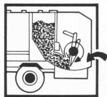
REFOULEMENT DES ORDURES MENAGERES PAR UN PEIGNE MOBILE.
