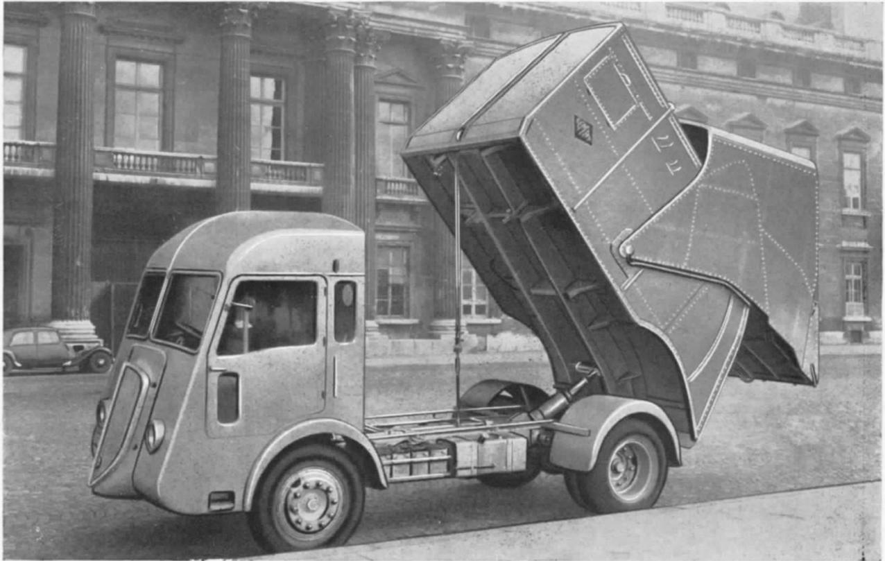
La benne OSEM à chargement automatique, type 2 C (10/12 m<sup>3</sup>), en basculement.
