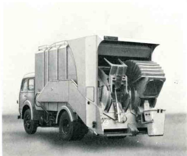
Benne REY équipée de deux appareils hermétiques standards.
