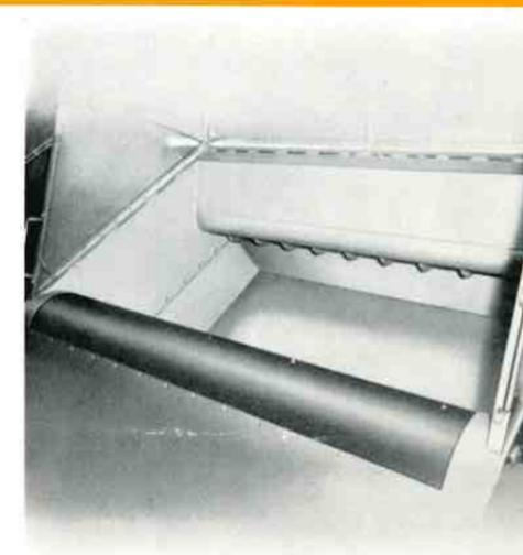
Dispositif à dents permettant le déchetage des cartons et cageots
