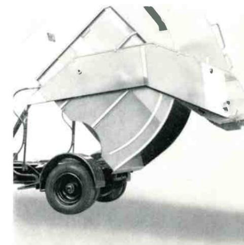
Basculement immédiat sans déverrouillage préalable de la porte arrière. Angle de vidage 51°.
