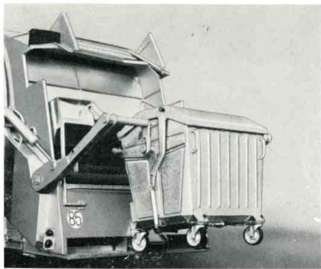
Benne REY équipée d'un appareil permettant la collecte de containers de 1.100 litres.
