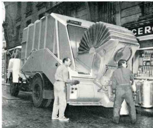
Benne REY équipée d'un appareil hermétique pour la collecte de poubelles standardisées.
