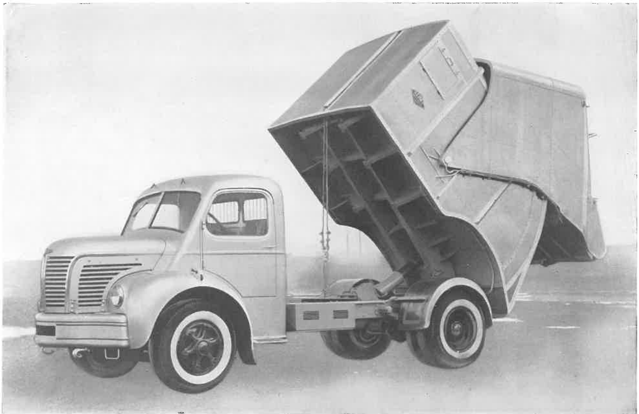
Benne OSEM à chargement automatique, type 2 C (10/12 m 3 ), en basculement
